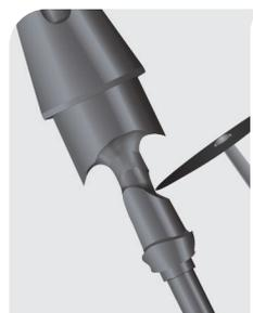
**4** Separar el abutment cortándolo del Raw-Abutment® con un disco separador
